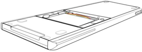
6. Setzen Sie die Abdeckplatte wieder auf und befestigen Sie die Schrauben mit einem Schraubendreher.
