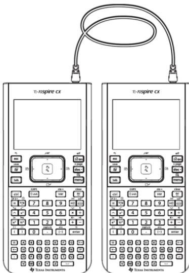
Der USB-Anschluss befindet sich oben rechts am TI-Nspire™ CX Handheld (wenn Sie das Handheld so halten, dass der Bildschirm zu Ihnen zeigt).
